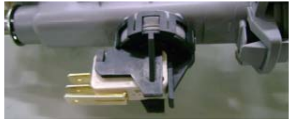
Distributeur Position 1 : Bras supérieur Position 2 : Bras inférieur
