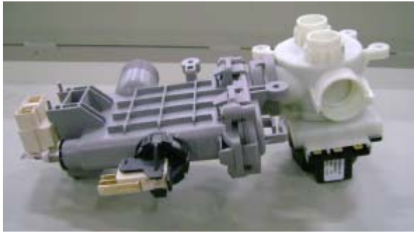
Groupe résistance avec distributeur 8W – 6840 ±5ohm
