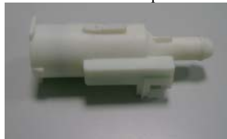
Flow-mètre Inclus dans l'air-break 208 rotation ±6 par L
