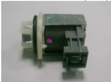
Electrovanne régénération 6W – 4130 ±10ohm (25C°)
