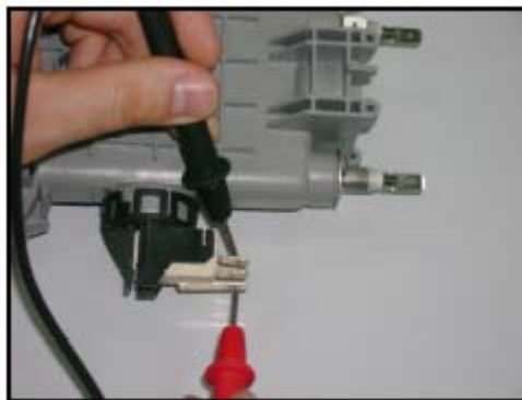
0 \Omega (avec eau) et \infty \Omega (sans eau)
